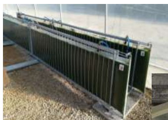
Fotobioreattori verticali Green Wall Panels (GWP)
