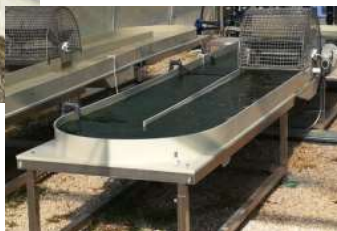
Vasche aperte RaceWay Ponds (RWP)
